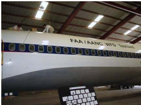
应用自动铆钉孔检测系统于波音727飞机实验床
